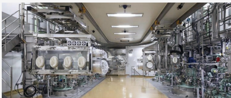
封じ込めレベル 0.05\mu\text{g}/\text{m}^3 以下のアイソレーター
