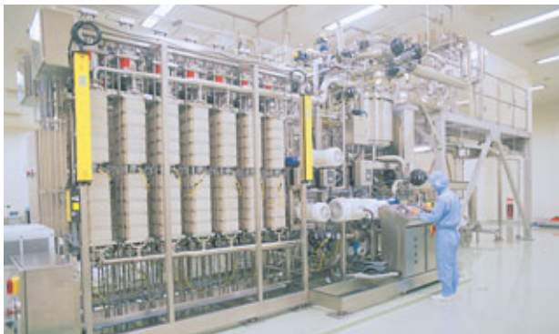
細胞分離工程：培養液から細胞を除去
