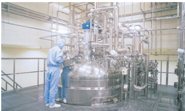
生産培養工程：1万L培養層へ移植し生産培養
