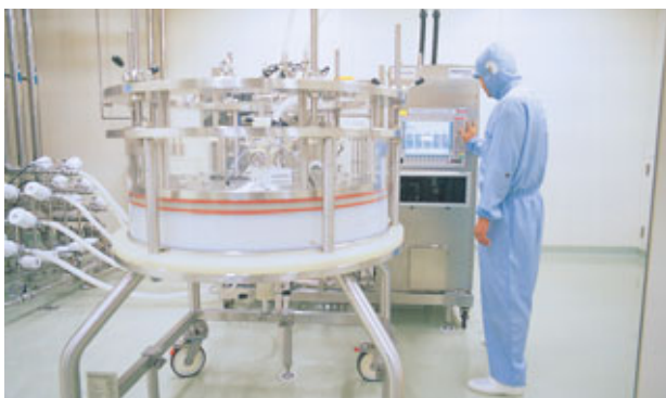
カラムクロマトグラフィー工程：カラムクロマトグラフィーにより、不純物を取り除き抗体を高純度化
