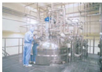
生産培養工程：1万L培養層へ移植し 生産培養
