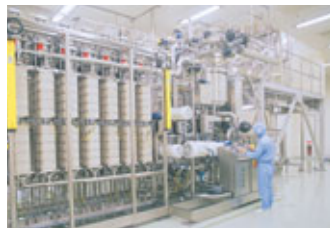
細胞分離工程：培養液から細胞を除去
