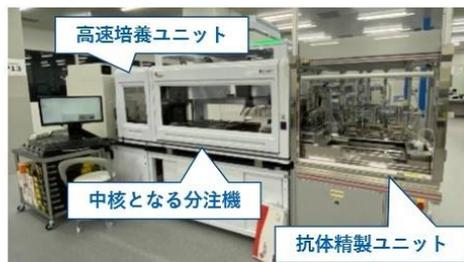
細胞培養(左側)と抗体精製(右側)の2つの実験を1台の分注機(中央)で実施。稼働率・投資効率を高めている
